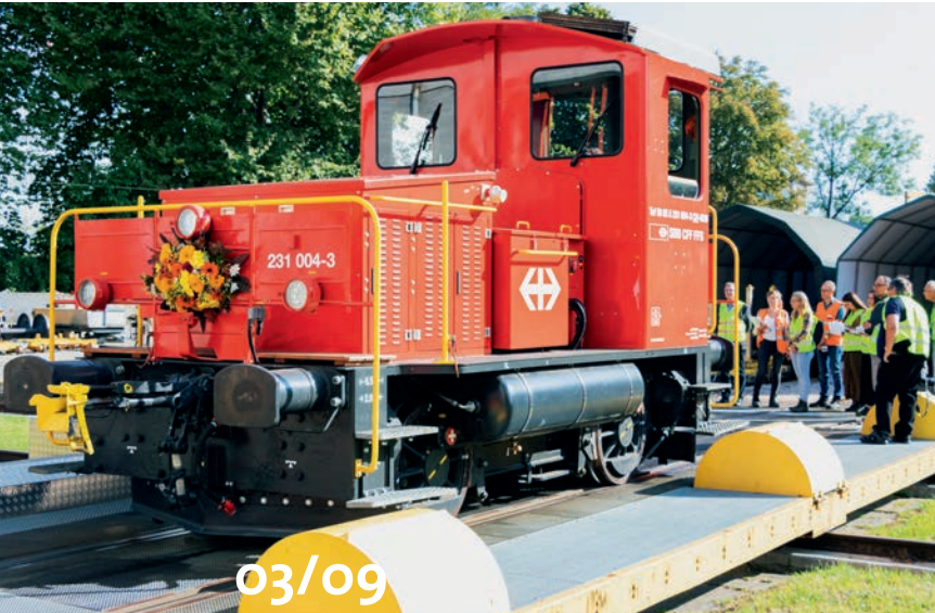
Prototype Taf 200: l'ancienne locomotive de manœuvre équipée d'une motorisation diesel roule désormais de manière électrique
